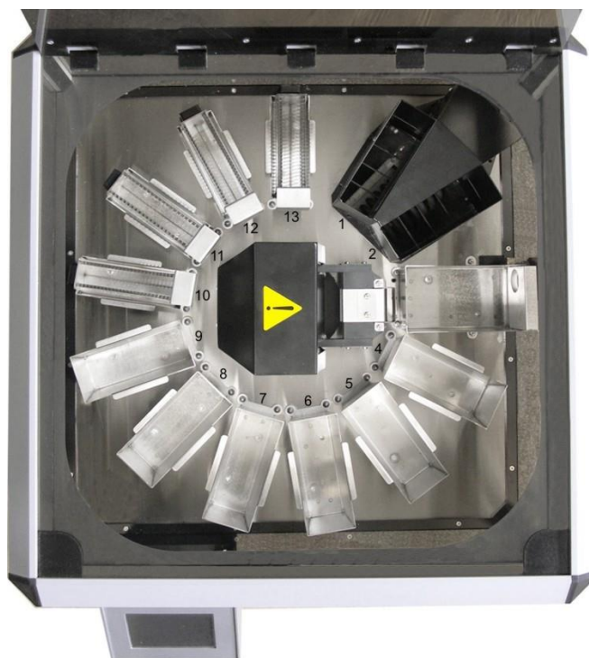
Рисунок 4. Рабочая камера автомата с установленными поддонами, ваннами и штативами (вид сверху).
